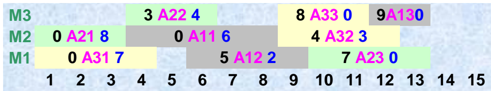
Abb. 25 Maschinenorientiertes Gantt- Diagramm
