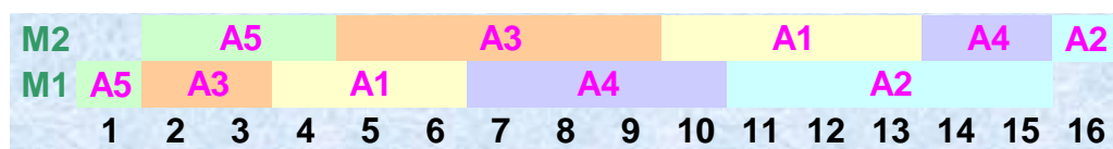
Abb. 19 Maschinenorientiertes Gantt- Diagramm
